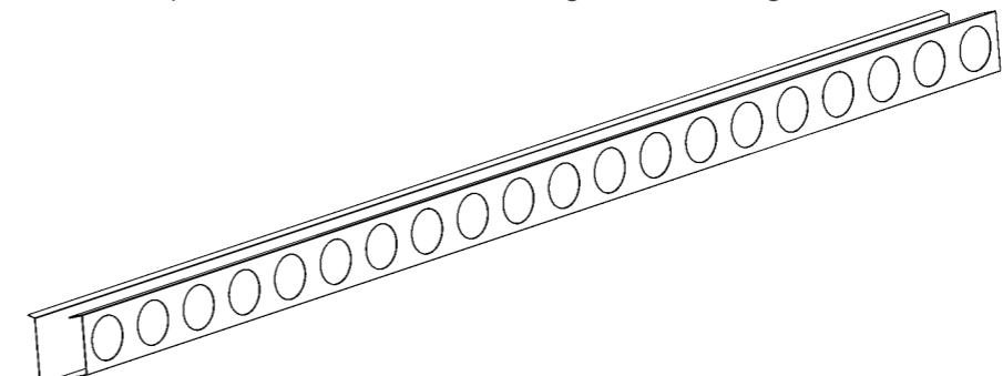
**L'utilisation d'UBAK® permet aux couvreurs la rapidité de pose d'un lanterneau grâce à une fixation simple et rapide sur toiture en fibrociment ou bac acier, et indifféremment sur une charpente bois ou métallique.**
