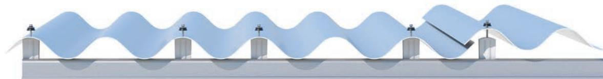
Les fixations sont placées sur les sommets des 1<sup>ère</sup>, 3<sup>ème</sup>, 4<sup>ème</sup> et 6<sup>ème</sup> ondes
