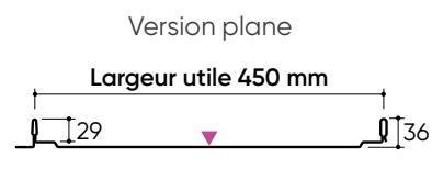
Longueur de profilage : Minimale 1800 mm / Maximale 12 000 mm
