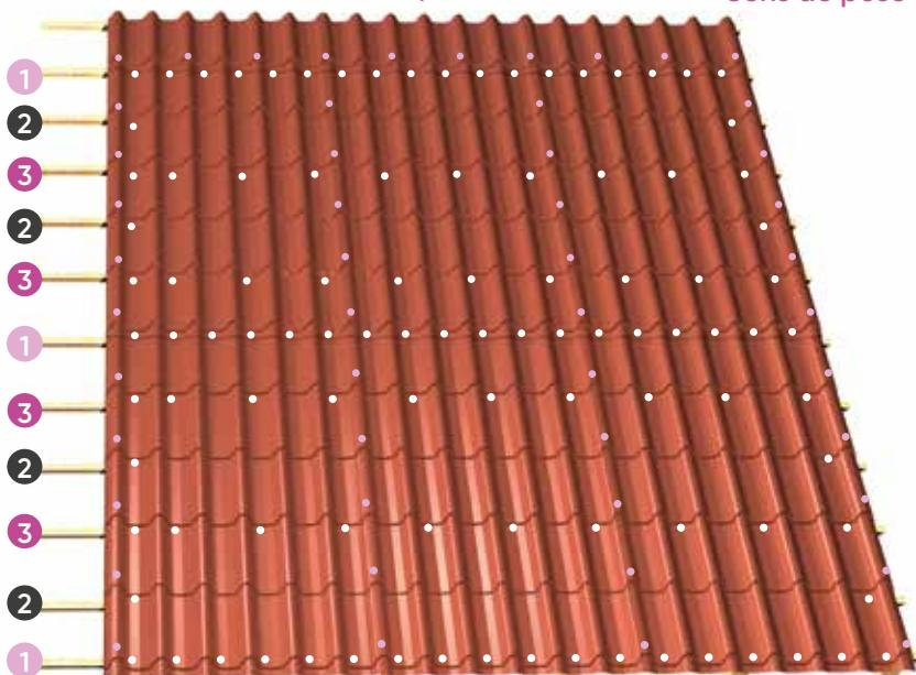
Fixations à l'égout, au faîtiage, au recouvrement transversal éventuel et sur les rives
